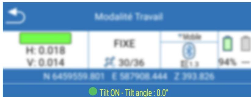
Si elle n'est pas activée, appuyez sur le bandeau « Capteur désactivé » (6) pour accéder au menu d'activation et de paramétrage de la centrale inertielle. Sélectionnez « Corrections du Tilt » (7) et validez (8).
